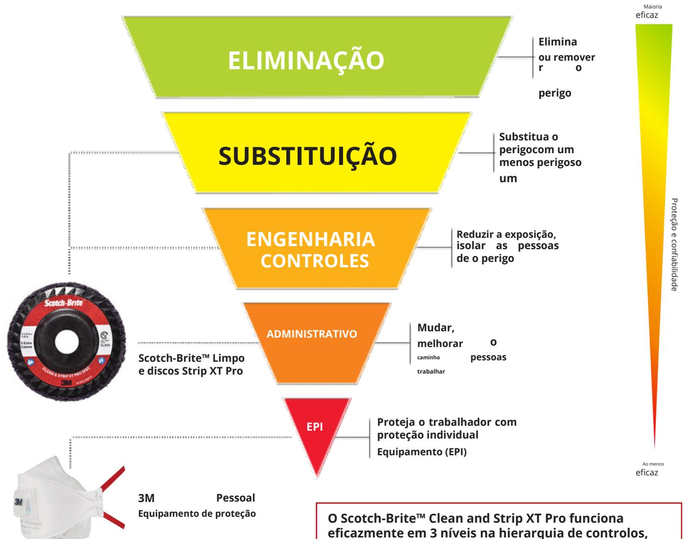
O Scotch-Brite™ Clean and Strip XT Pro funciona eficazmente em 3 níveis na hierarquia de controles, dependendo do risco original. Por exemplo, a substituição de uma aplicação de roda de arame por XT Pro pode reduzir o risco de corte e eliminar o risco de fios soltos (substituição).
