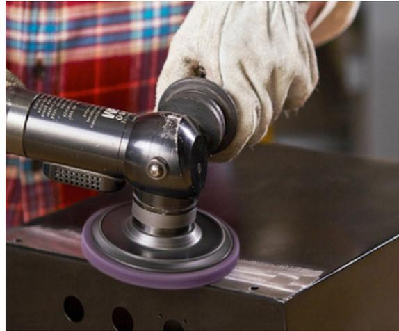
O Disco Scotch-Brite™ Clean and Strip XT Pro foi concebido para remover tinta, para ajudar a minimizar a vibração:
